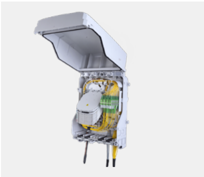
Abbildung 9: Polarisbox als Glasfaser-Gebäudeübergabepunkt (Gf-Güp) (Quelle: R&M - Reichle & De-Massari AG)
